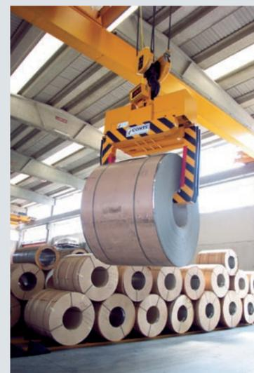
Pinza per coils mod. 304 + sistema di pesatura
