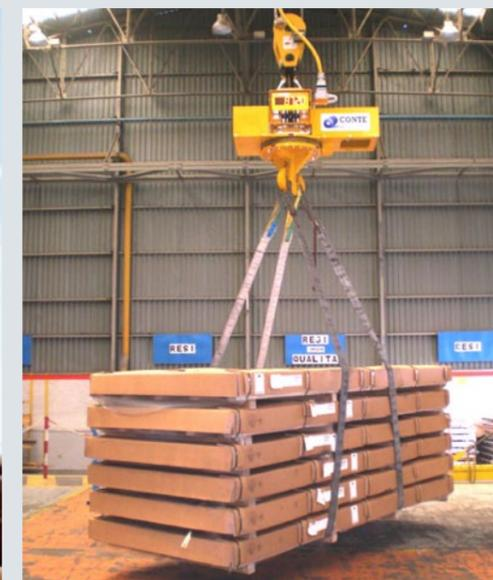
Rotazione motorizzata mod. 1522 con pesatura
