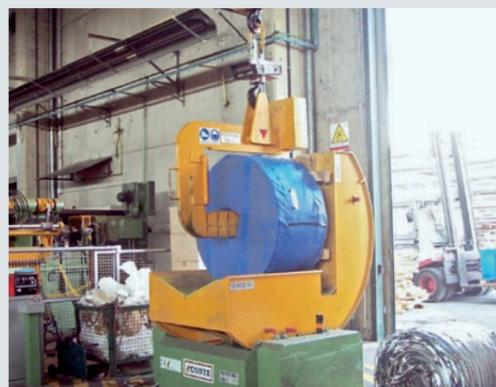
Ribaltatore per coils + pallet mod. 101
