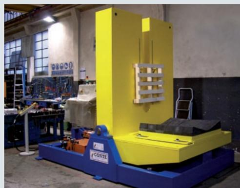
Ribaltatore per coils mod. 105 + sistema ferma pallet
